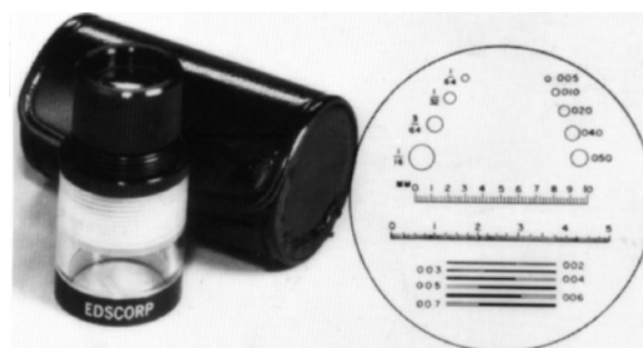
Fig. 2.1 – Comparador para medir anchos de fisura (cortesía de Edmund Scientific Co.)
